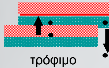
Εικ.3 Μεταφορά μέσω επαφής 'set-off'
